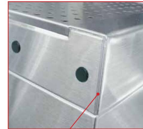
Die ineinander greifende, gesäumte Kantenkonstruktion erzeugt mehrere Lagen Edelstahl für zusätzliche Stabilität an den Ecken.
