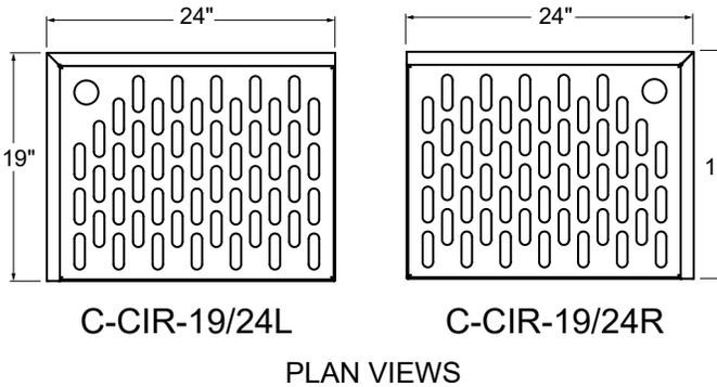
**CORNER INSIDE RECTANGLE DRAINBOARDS WITH CHAMFERED BACK CORNER**
